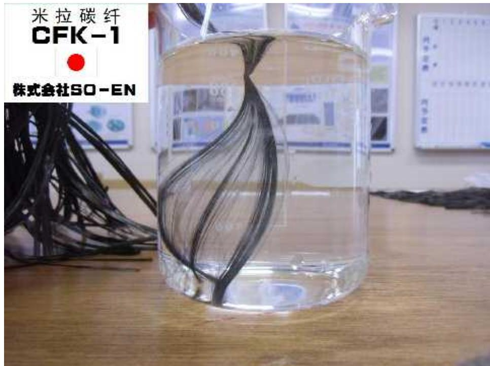
观察：因为对CFK-1实施了水溶性上浆剂的表面处理，所以放入水中后瞬间扩散开。
